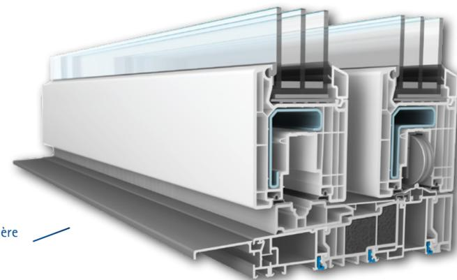
Le seuil de porte nouvellement développé permet d'excellentes valeurs d'isolation thermique grâce à la double rupture de pont thermique avec cale d'isolation et empêche les zones plus froides du sol.
